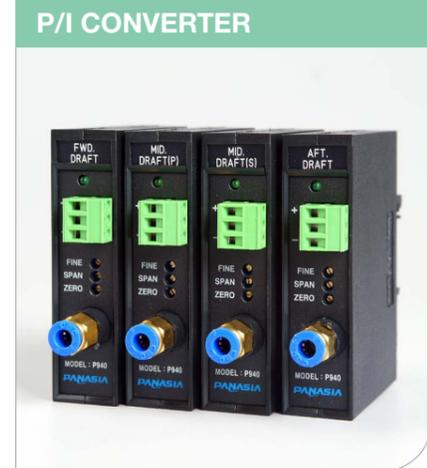
수두압을 전류값(4~20mA)으로 변환하기 위해 strain gauge를 사용하며, 별도의 게이지 보호장치가 없어도 과압으로부터 영향을 받지 않으며 전류 제한장치를 내장하고 있어 최대 출력값을 제한 합니다.
