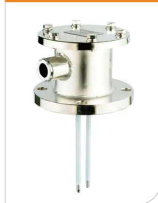
해수감지 스위치는 화물창(cargo hold) 내부 바닥에서 0.5m이상 높이 위치(pre-alarm)에 설치되며 화물창 깊이의 15%보다 적고, 2.0m를 넘지 않는 위치(main alarm)에 또 하나 설치됩니다. 체인로커외의 dry space 또는 void space와 최전방 화물창의 전방에 위치하고 선박의 최대 배수량의 0.1%를 초과하는 부분에 감지 스위치가 설치되어야 하며, 갑판 위 0.1m 높이에 설치됩니다.
